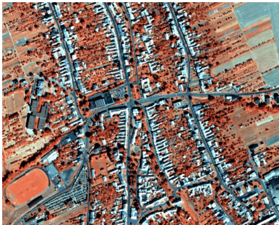
Snímek ze střední infračervené části spektra, co už lidské oči nevidí. Čím tmavší červená, tím více vody v daném objektu (viz srovnání např. stromů a střech), vyjma stínů.
