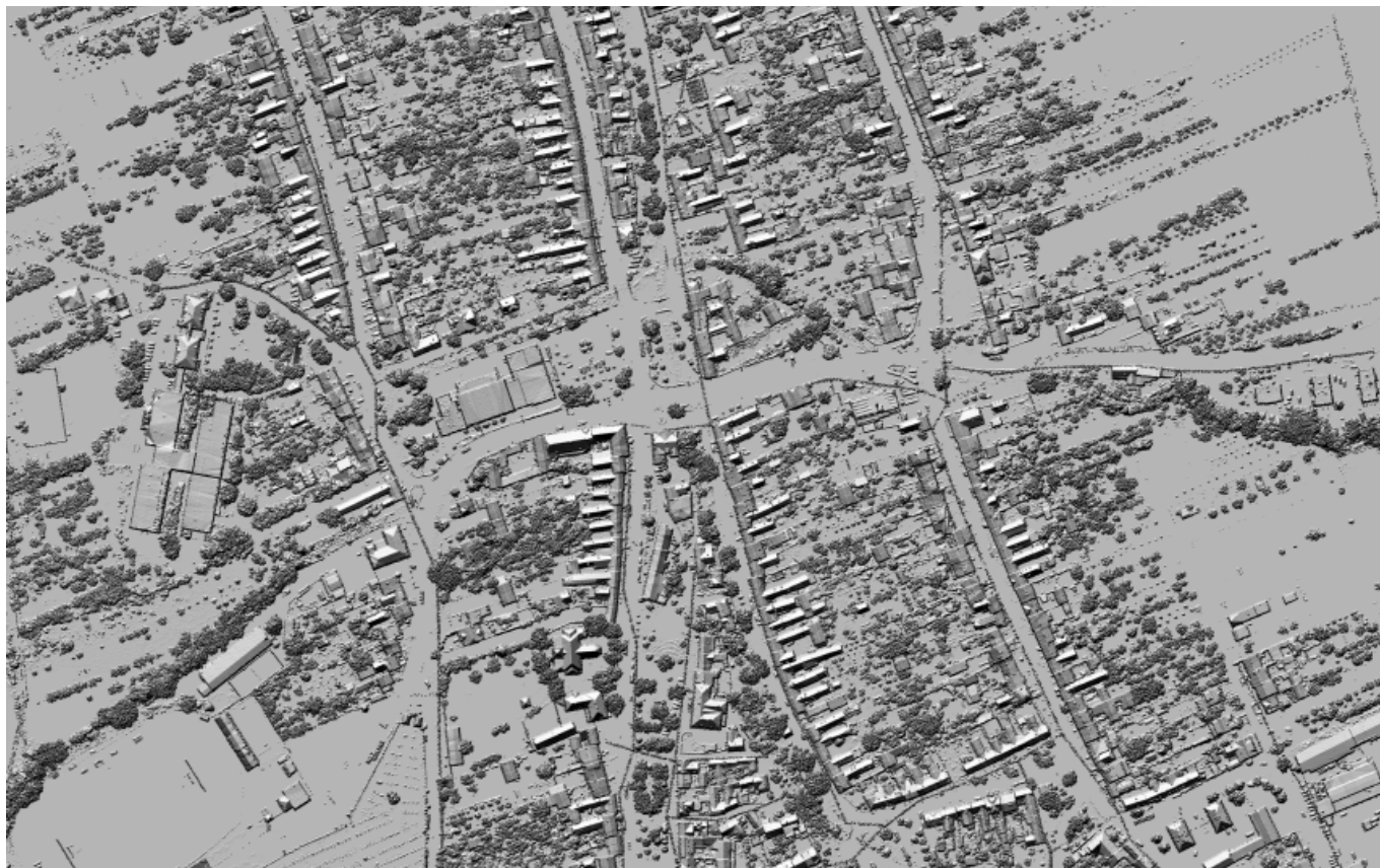
Stínovaný model povrchu obce z dat, snímaných LiDARem.
